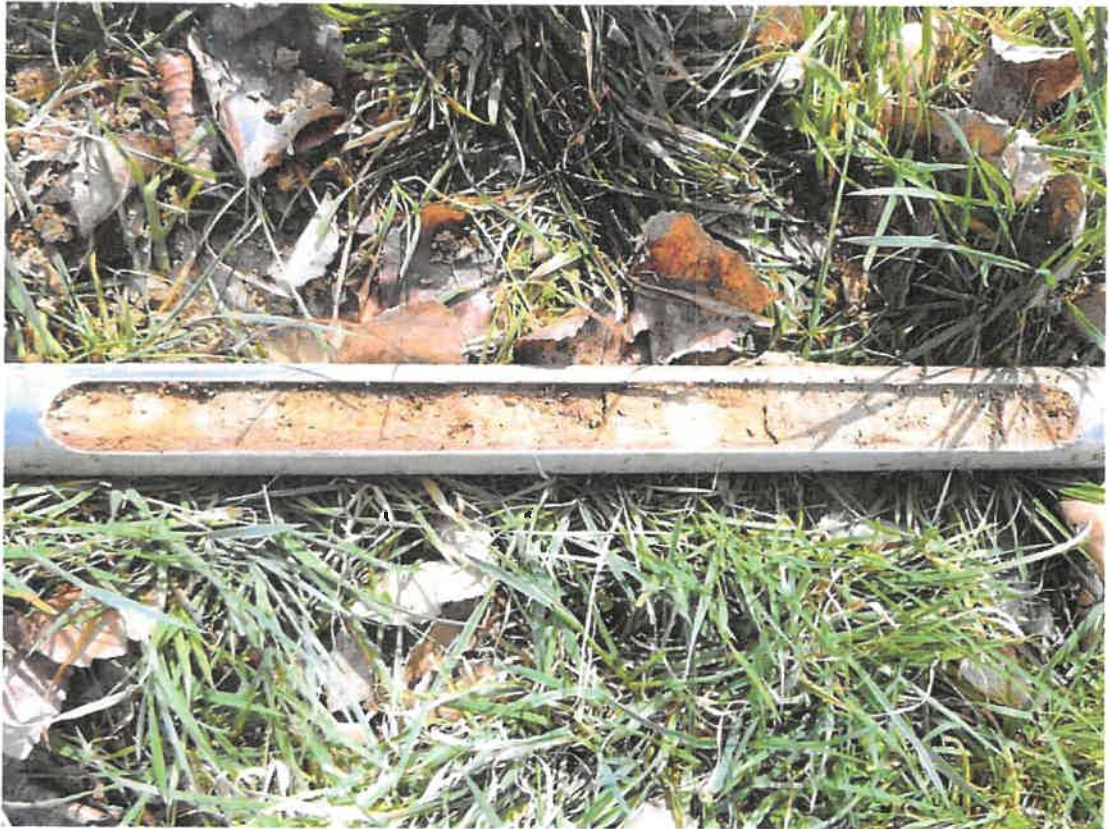
Bild 5: Mitte S-Seite, Feinsand bis Mittelsand, schluffig, schwach tonig, bei 2,0-2,5 m.
