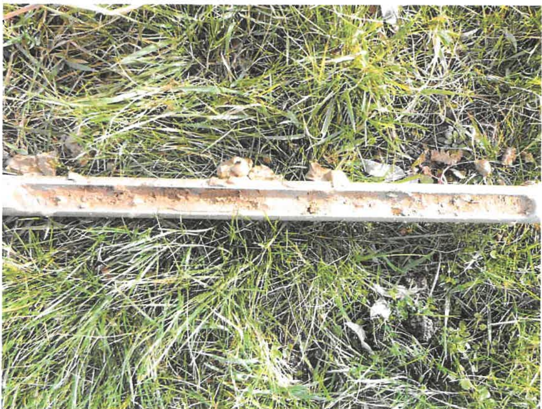
Bild 6: Mitte O-Seite, Feinsand, über Geschiebelehm, sandig, Bereich bei 4,5-5,0 m.
