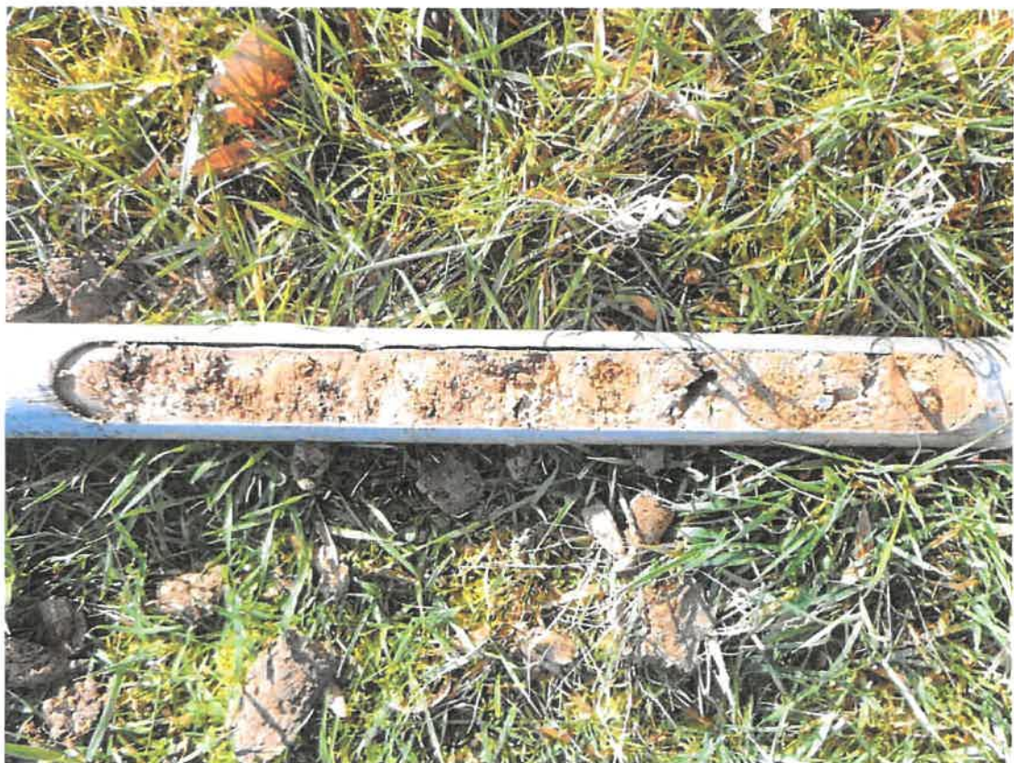
Bild 4: SW-Ecke, Schluff, sandig, bei 0,5-1,0 m.
